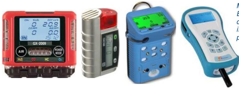
Monitores personales para detección de gases en espacios confinados. Equipos para detección de un unico gas, y modelos multigas. En función de la aplicación, la atmósfera puede contener una mezcla de sustancias inflamables y tóxicas o presentar una disminución del oxígeno a niveles peligrosos. Los gases que más habituales que nos podemos encontrar:
