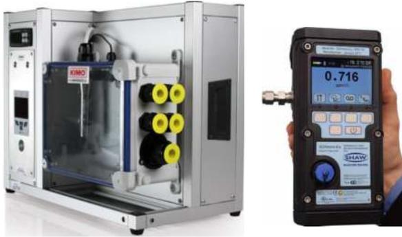
Destinado a los expertos en metrología, los generadores de higrometría permite, calibrar instrumentos de medición higrométrica en laboratorio o in situ, son equipos adecuados para el ajuste y calibración de sensores higrométricos.
