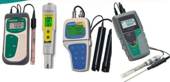
Equipos portátiles y de campo. Con estos instrumentos de medida para el análisis del agua podrá medir algunos parámetros críticos del agua como el pH, el cloro libre y el cloro total, el cianuro y la dureza del agua de una manera muy sencilla.
